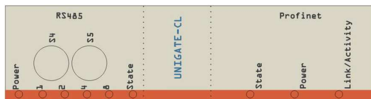
Bild 2: Frontblende: Drehschalter und Leuchtanzeigen
