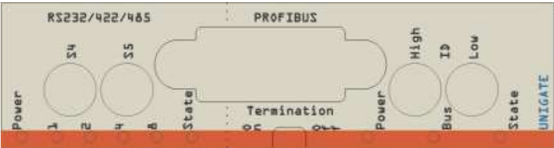
Bild 2: Frontblende: Drehschalter und Leuchtanzeigen
